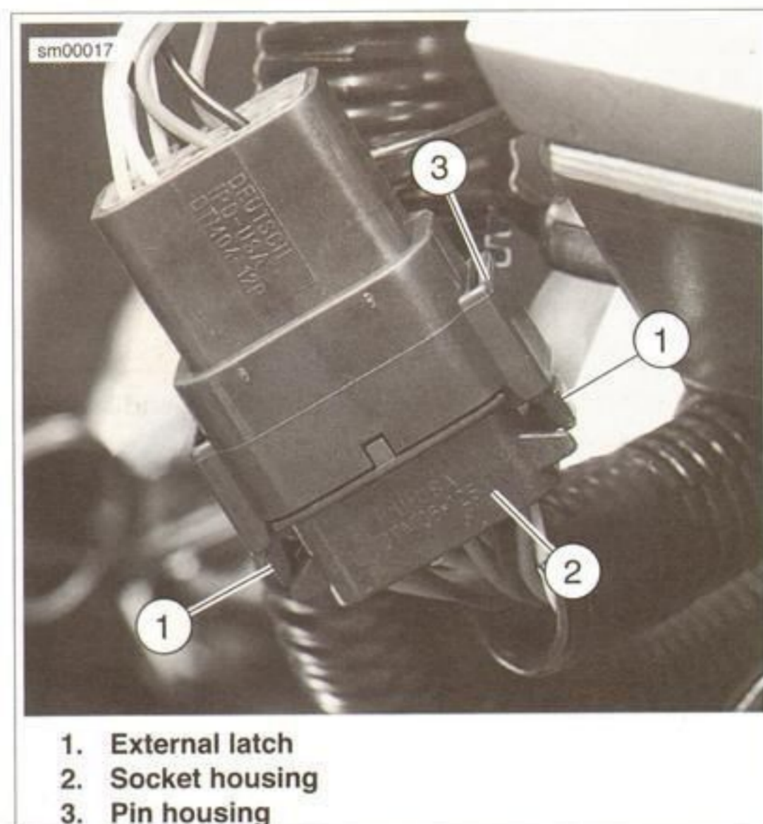
Figure A-15. Deutsch Connector
